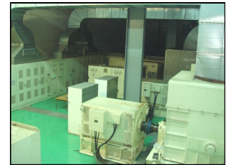
(d) Generator drive for transformer test
